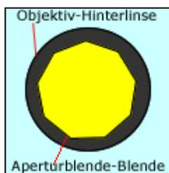
Die Stellung „10x“ (oder „40x“) an der Aperturblende (Zeissmikroskope) entspricht einer so großen Schließung der Blende, dass nur noch  $2/3$  der Objektivhinterlinse sichtbar bleibt. So eingestellt liefert die Köhlersche Beleuchtung ein optimal gleichmäßig ausgeleuchtetes Bild mit gutem Kontrast und Auflösungsvermögen.
