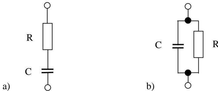
Bild 4: Ersatzschaltbild einer Zellmembran als a) Reihen- und b) als Parallelschaltung einer Kapazität C und eines Widerstandes R.
