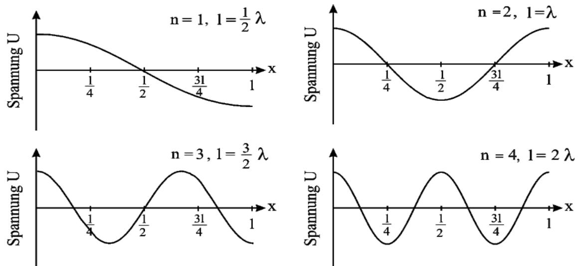
Bild 1: Stehende Wellen in einem longitudinal schwingenden Stab (Enden nicht eingespannt).
