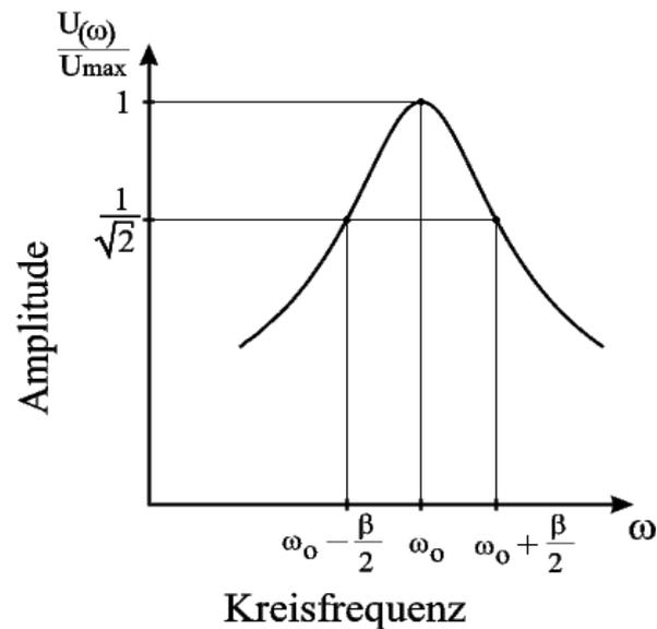
Bild 2: Amplitude des gedämpften Oszillators in Abhängigkeit von der Erregerfrequenz.
