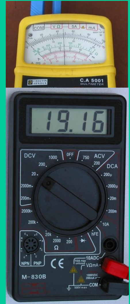
Strom-, Spannung- & Widerstands- messung
