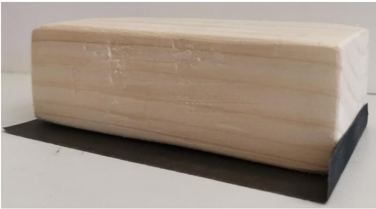
Vor Holzklötz geknicktes Schleifpapier
