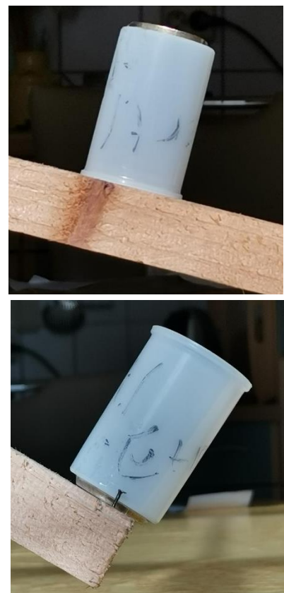
oben: Dose mit Münze oben unten: Dose mit Münze unten und Fixierung mit zwei Nägeln gegen Wegrutschen
