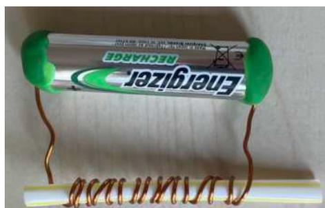
3. Schalte in der Phyphox App den Magnetfeldmesser an und führe dieses in die Nähe des Aufbaus. (Hinweis: Bei den meisten Smartphones befindet sich der Magnetfeldsensor oben neben der Kamera)
