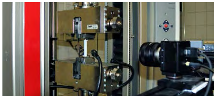
Versuchsaufbau für die Zugprüfung – zur Verifizierung der Werkstoffmodellierung und der Simulationen, im Vordergrund befinden sich die Kameras des optischen Messsystems (ARAMIS).
