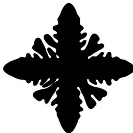
Mit Hilfe eines amorphen, unstrukturierten Gitters simulierter Dendrit
