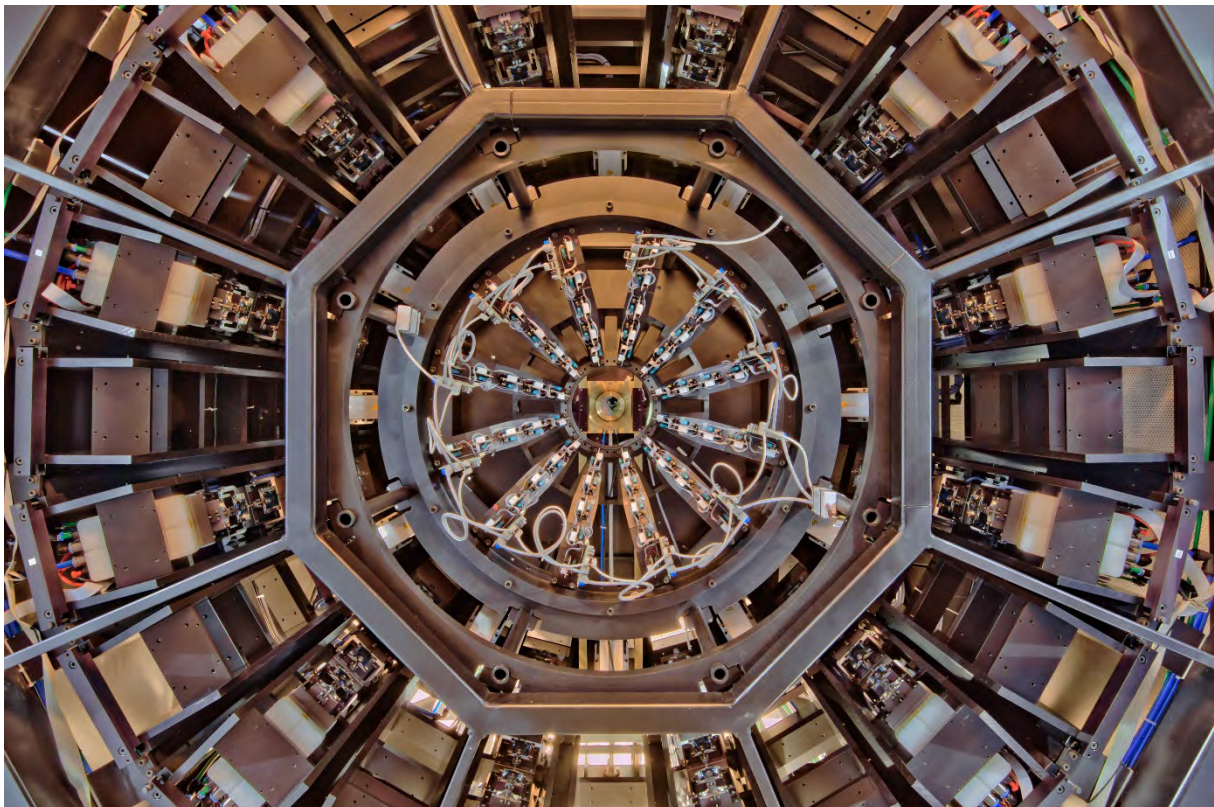
Blick in den letzten Verstärker von POLARIS mit einem 65-mm \text{CaF}_2 -Kristall im Zentrum
