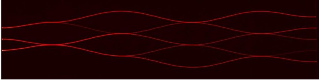
Fluoreszenzaufnahme der Lichtpropagation in einem integriert-optischen Quantengatter
