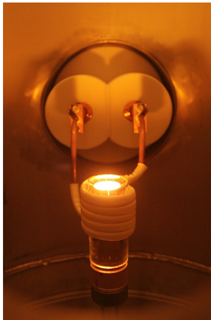
Erschmelzen von Legierungen im Levitationsofen
