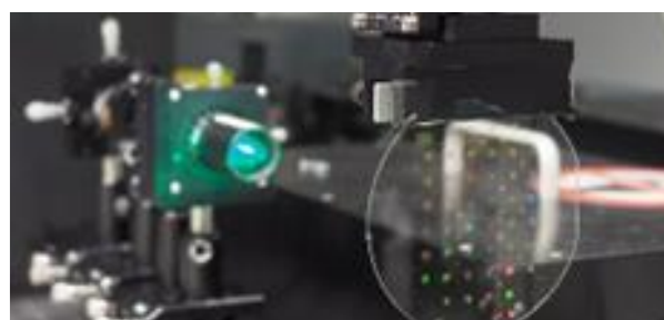
Abb. 3. Charakterisierung von plasmonischen Nanostrukturen mithilfe eines fs-Lasers.
