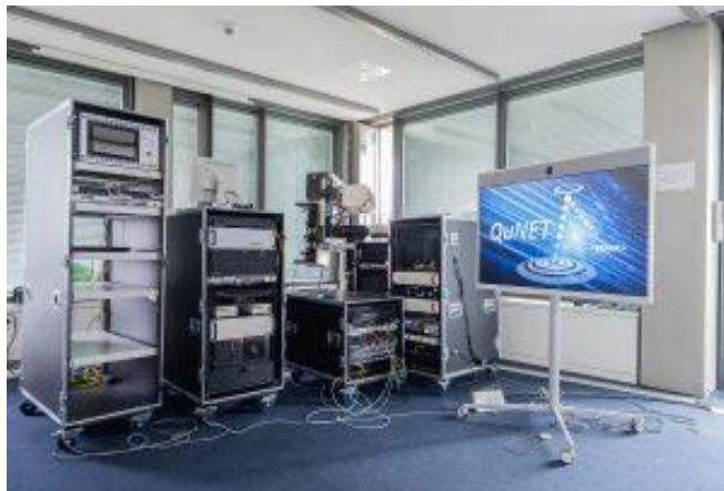
Abb. 2: Technikaufbau zur Demonstration einer quantenverschlüsselten Videokonferenz zwischen BMBF und BSI mit HHI-QKD-System im Rack und Teleskop.
