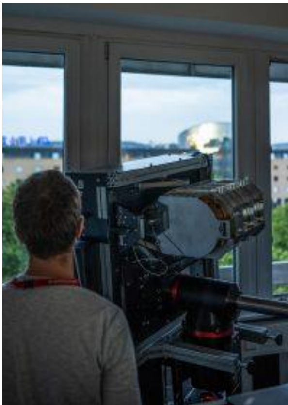
Abb. 1: 300 m Luftlinie trennen das BMBF und das BSI. Die Übertragung der Quantenschlüssel fand über zwei Freistrahlsowie eine Glasfaser-Verbindung statt.
