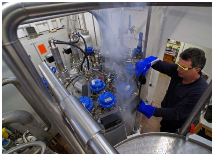
Arbeiten am neuen Heliumverflüssiger
