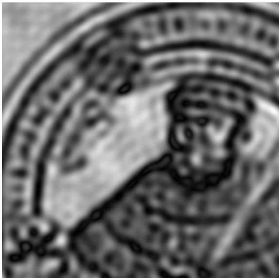
Mit digitaler Holographie rekonstruiertes Objekt mit einer Fläche von 140\ \mu\text{m} \times 140\ \mu\text{m} (links: Originalapertur NA = 0,12 ; rechts: synthetische Apertur NA = 0,24 )
