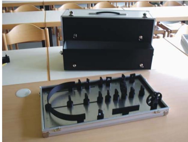
Baukastensystem zur Demonstration optischer Experimente
