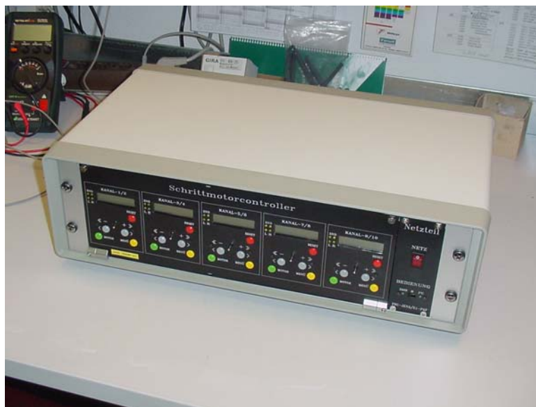
10-kanalige modulare Schrittmotorsteuerung für Verstelleinheiten von Laserspiegeln des POLARIS-Lasersystems
