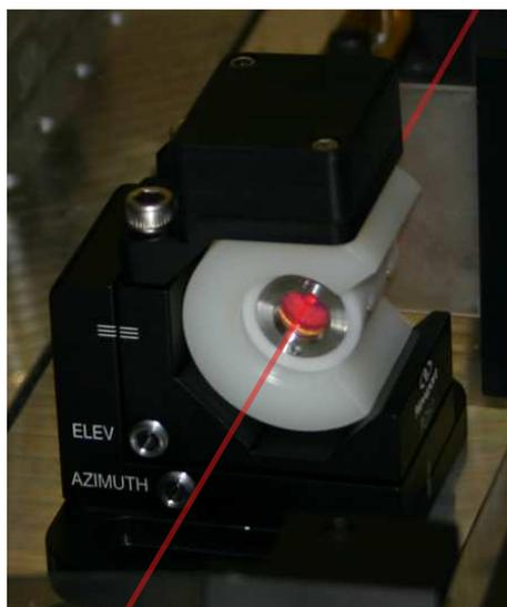
**Abbildung 4.9.:** Pockelszelle in Fassung. Eingezeichnet ist der Strahlverlauf. Mittels der Halterung lässt sich die Pockelszelle in zwei Achsen verkippen.
