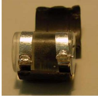
**Abbildung 2.7.:** Eine zerlegte longitudinale Pockelszelle (KD\*P), deren Kontaktierung ringförmig um den Kristall gelegt ist. Durch die Demontage sind die Silberkontaktierungen für die Hochspannung verrutscht, welche sich am Ende des Kristalls befinden. Das schwarze Material dient der Isolierung.
