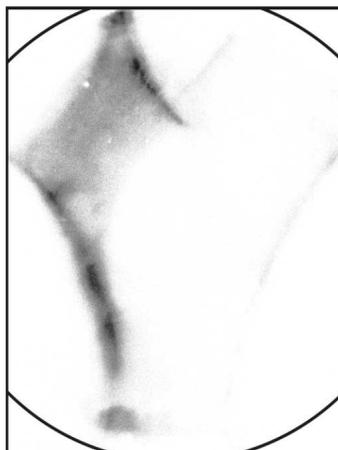
**Abb. 5.4:** Signal des Schirmes am Ende des Kanals. Der Rand des runden Leuchtschirms ist eingezeichnet. Im Gegensatz zu Abb. 5.2 gilt hier: Je dunkler, desto mehr Elektronen treffen den Schirm.
