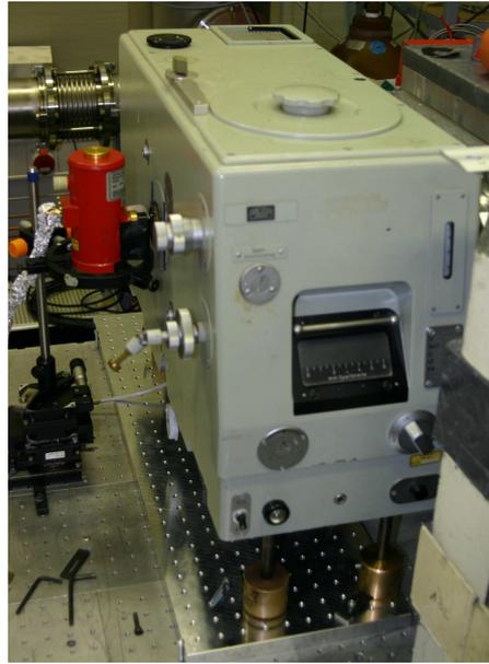
**Abb. 3.25:** IR-Spektrometer und IR-Detektor (rot) zur Detektion der Undulatorstrahlung. Dieser Teil des Aufbaus schließt am Elektronenspektrometer an.
