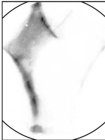
**Abb. 3.9:** Leuchtschirmsignal am Ende des Quadrupolkanals. Je dunkler der Schirm desto mehr Elektronen.
