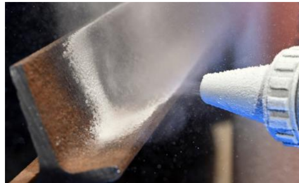
Abb. 2. Eispartikelstrahlen zum Entrosten und Reinigen von Stahlbauteilen. Foto: Jan-Peter Kasper.
