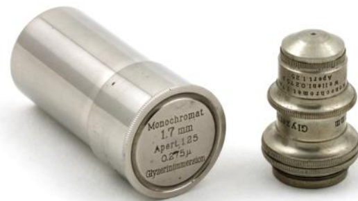
Abb. 1. Monochromat für die Mikroskopie bei 275 nm von Carl Zeiss Jena aus dem Jahre 1907
