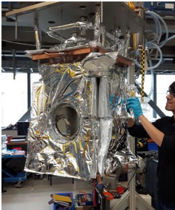
Abb. 1. CCC-Kryostat für das FAIR-Projekt vor Integration des CCCs in die beam line.
