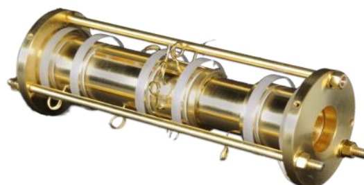
Abb. 1. Fotografie der HILITE-Penningfalle. Foto: Manuel Vogel, GSI und HI Jena.
