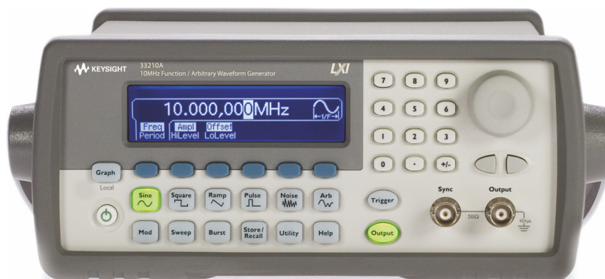
Abbildung 4: Front Panel des Funktionsgenerators Agilent (bzw. Keysight) 33210A, entnommen aus dem Datenblatt. Der BNC-Ausgang ist mit Output beschriftet. Die mit Sync bezeichnete BNC-Buchse gibt ein Rechteck-Signal synchron zur eingestellten Grundfrequenz aus. Die Output -Taste muss gedrückt werden und grün leuchten, um den Ausgang zu aktivieren.
