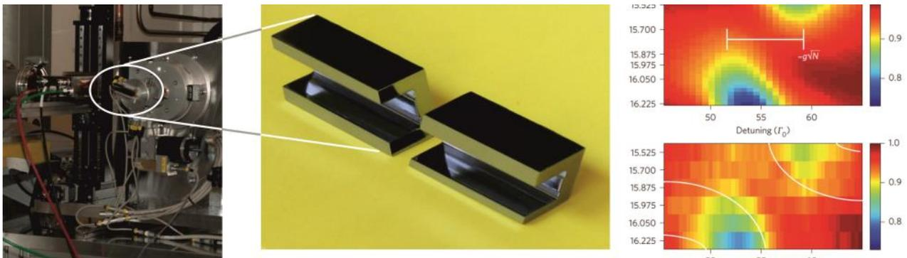
Röntgenpolarimetrie zum Nachweis starker Kopplung zwischen Röntgenphotonen und Eisen-Vielschichtsystemen. Links: Röntgenpolarisator; Mitte: Silizium Channel-Cut Kristall als zentrales Bauteil des Polarisators; Rechts: Nachweis der starken Kopplung, Vergleich von Simulation und Messung der Abhängigkeit des Spektrums der kernresonanten Photonen vom Einfallswinkel der Strahlung auf die Schichtstruktur.
