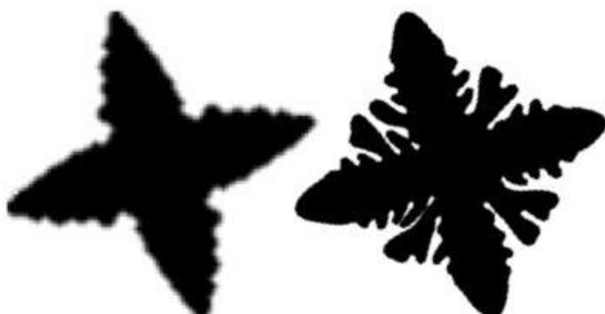
Abb. 1: Durch Simulationsrechnungen erzeugte Dendriten; Zelluläre Automaten führen zu unsymmetrischem Wachstum der Sekundärarme (links), die neu entwickelte Meshless Front Tracking Methode behebt dieses Problem.
