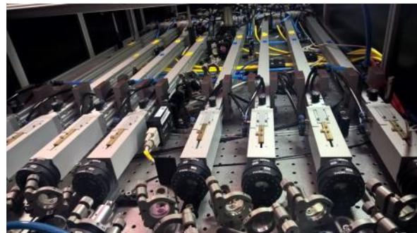
Abb. 2. Lasersystem mit 8 kohärent kombinierten Faserverstärkern.
