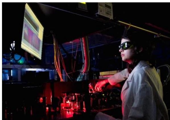
Abb. 2. Im Rahmen des ACP Explore Projektes „XUV Interferometrie“ testet Vittoria Schuster in Kooperation mit der AG Limpert unterschiedliche Geometrien der Harmonischenerzeugung für einen optimalen Photonenfluss im Extremen Ultraviolett.
