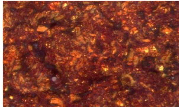
Abb. 2: Gefüge einer Li-C-Interkalationsverbindung, präpariert unter Ausschluss von Sauerstoff unter Verwendung absolut wasserfreier Lubrikanten. Trotz der enormen technischen Bedeutung des Materials ist dies das erste veröffentlichte Gefügebild.
