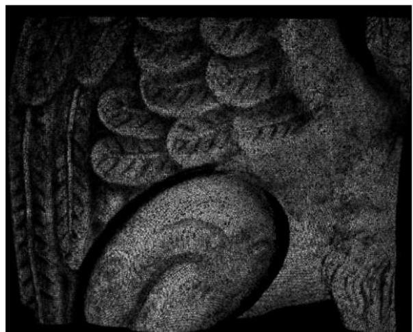
Abb. 2. Bild der 3D-Rekonstruktion eines mit Speckles beleuchteten Objektes (Greifenstatue).
